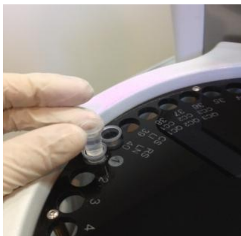
Chargement à partir d'un gobelet d'échantillon
