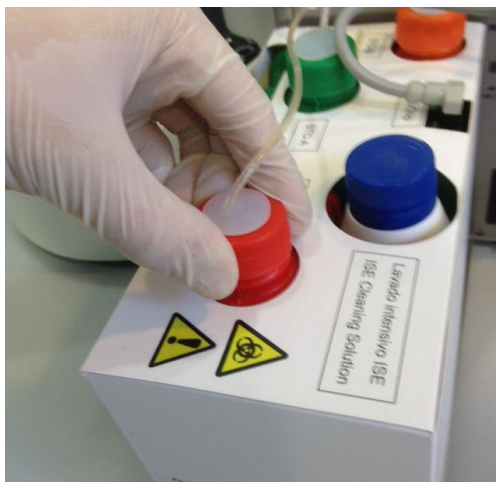
Fermeture du bouchon de décharge
