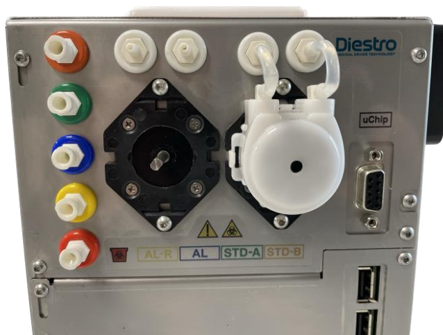
Vista de la bomba peristáltica con el cabezal extraído
