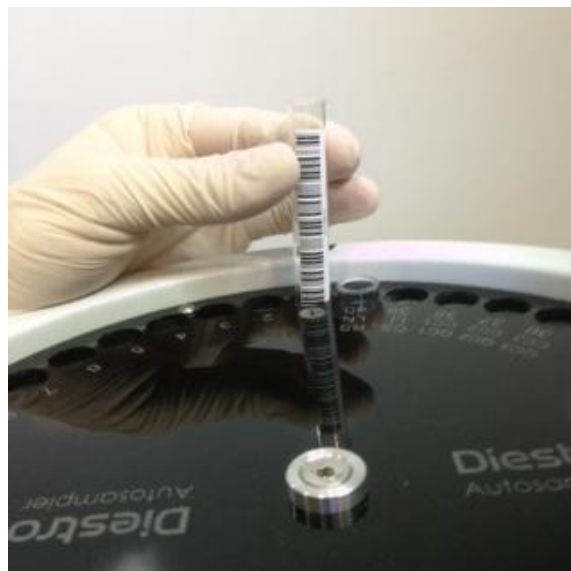
Correcta colocación del tubo
