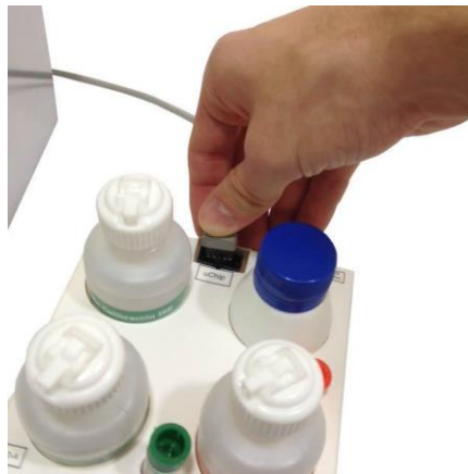
Desconectando el uChip
