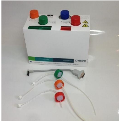
Vista del Pack y sus tuberías de conexión
