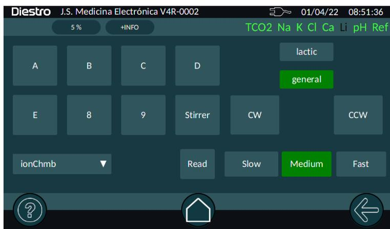
Pour positionner manuellement StdA, appuyez sur le bouton « A », puis sur CW (avec General Persitáltica activé), jusqu'à ce que le liquide soit amené à la position souhaitée. En appuyant sur « Lire », vous pourrez voir la conductivité dans le détecteur sélectionné (voir carte)
