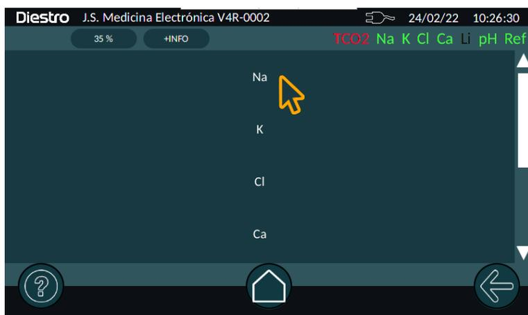
Appuyez sur l'analyte choisi pour afficher un graphique où vous pouvez voir l'évolution des mesures, les limites de ce contrôle et les écarts-types représentés par des lignes pointillées horizontales pour +/- 1, +/- 2 et +/- 3 écarts-types.
