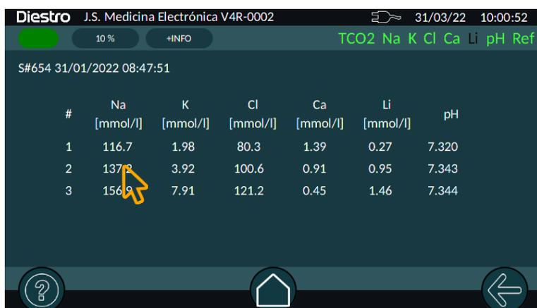
Appuyer sur la rangée d'un tube donné affichera les mesures de ce tube, ainsi que les statistiques calculées. Ceci est très utile pour le contrôle de l'équipement à l'aide de solutions calibrées.
