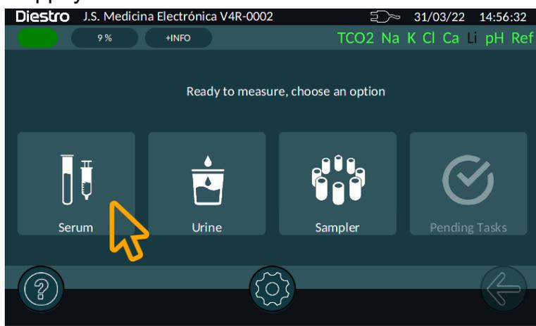
3.2-Dans le menu de mesure, vous pouvez choisir de mesurer le TCO2 (si installé), les IONS ou les deux. Dans cette étape, soulevez le levier (si vous ne l'aviez pas fait auparavant). Le chargement commencera automatiquement 1 seconde plus tard (configurable). Si cette option n'est pas configurée, appuyez sur « Charger » pour charger l'exemple.
